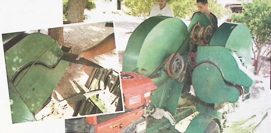
O protótipo da nova máquina. O detalhe mostra a forma de desfibrar, sem contato com o motor e sem risco de mutilação
